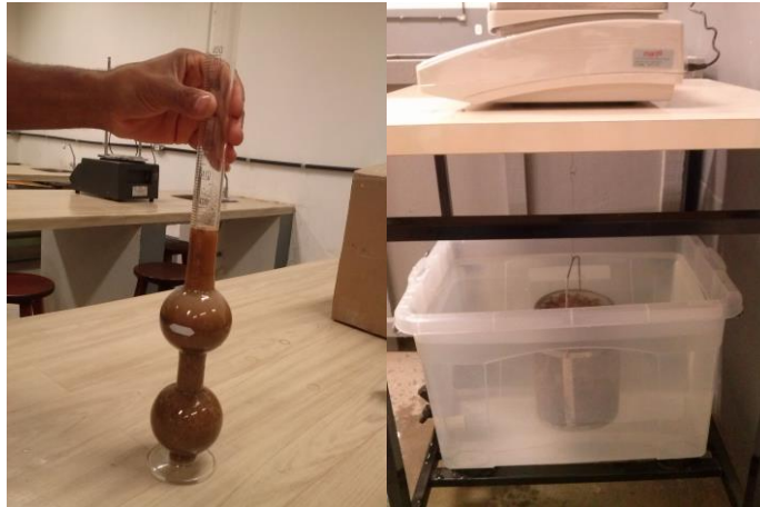
FIGURA 3 – ENSAIO DA MASSA ESPECÍFICA: AREIA (A) E DA BRITA (B). FONTE: OS AUTORES, 2015.
