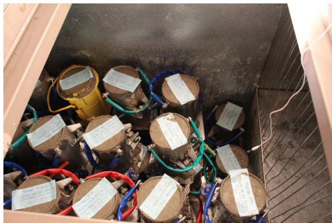
FIGURA 1 – CORPOS DE PROVA EXPOSTOS A BAIXA TEMPERATURA. FONTE: OS AUTORES, 2015.
