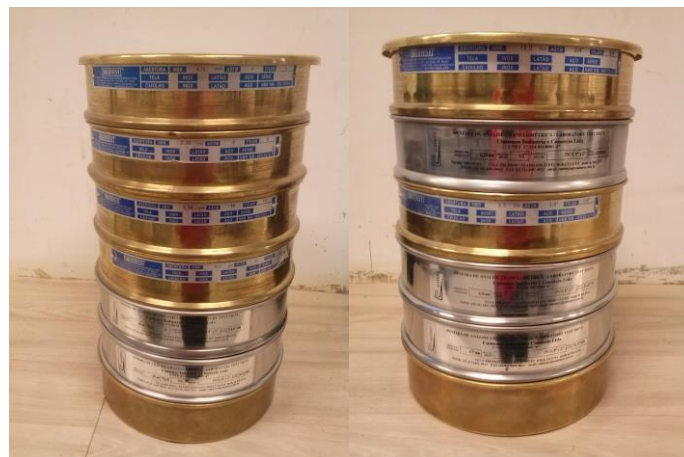
FIGURA 4 – ENSAIO GRANULOMÉTRICO: (A) AREIA E (B) BRITA. FONTE: OS AUTORES, 2015.
