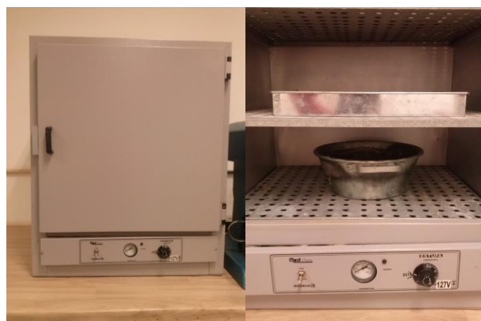
FIGURA 5 – ENSAIO: MATERIAL PULVERULENTO (ESTUFA). FONTE: OS AUTORES, 2015.
