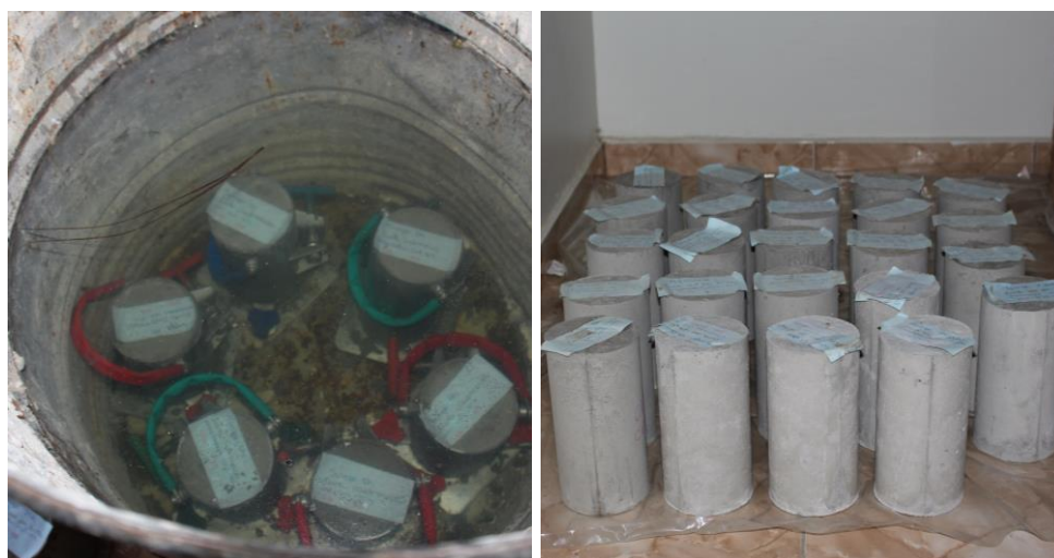
FIGURA 2 – (A) CORPOS DE PROVA EM CURA POR IMERSÃO / (B) CORPOS DE PROVA DESFORMADOS, EM CURA AO AR LIVRE. FONTE: OS AUTORES, 2015.
