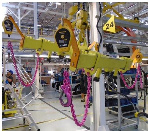
FIGURA 6: DISPOSITIVO DE PEGA DO MOTOR COM CORRENTES SUSPENSAS POR BALANCINS
