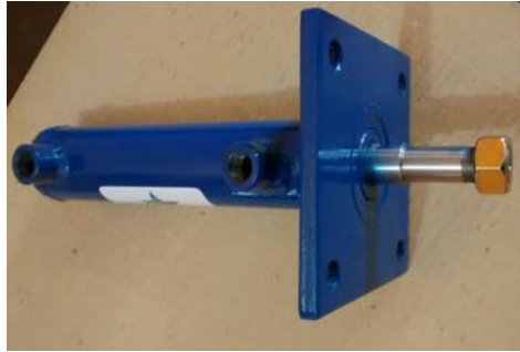
FIGURA 6: CILINDRO HIDRÁULICO DUPLA AÇÃO FONTE: OS AUTORES (2018).
