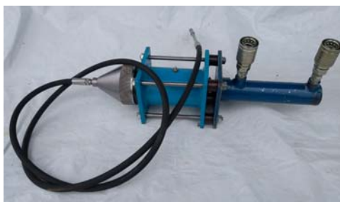
FIGURA 7: PROTÓTIPO TENSIONADOR HIDRÁULICO FONTE: OS AUTORES (2018).
