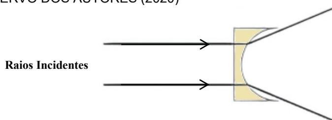
FIGURA 2: DIVERGÊNCIA DOS RAIOS POR UMALENTE BORDA GROSSA, DO TIPO PLANO CÔNCAVA, QUANDO  $n_L > n_m$ .
