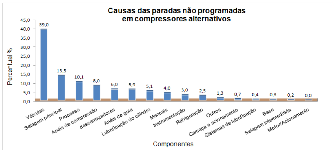
FIGURA 4: CAUSAS DE PARADAS NÃO PROGRAMADAS PARA COMPRESSORES ALTERNATIVOS FONTE: NÓBREGA (2011)
