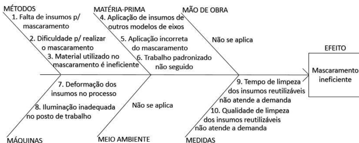
FIGURA 5: DIAGRAMA DE CAUSA E EFEITO. FONTE: ADAPTADO AAM DO BRASIL, (2018).
