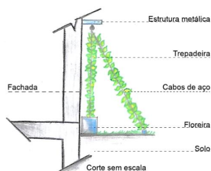
FIGURA 3 – SISTEMA DE CABOS FONTE: Os autores (2018).
