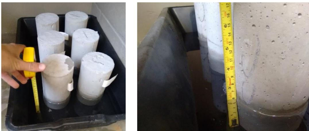
FIGURA 7 – ENSAIO POR CAPILARIDADE
