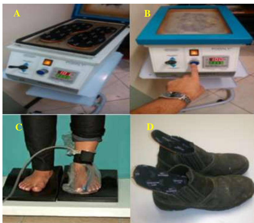
FIGURA 2: (2-A) INSERÇÃO DAS PALMILHAS NA MÁQUINA DE TERMOCOLOAGEM; (2-B) TERMOCOLOAGEM; (2-C) MOLDAGEM NO PÉ DO INDIVÍDUO; (2-D) INSERÇÃO DAS PALMILHAS NO CALÇADO. FONTE: KUTZKE,2015.
