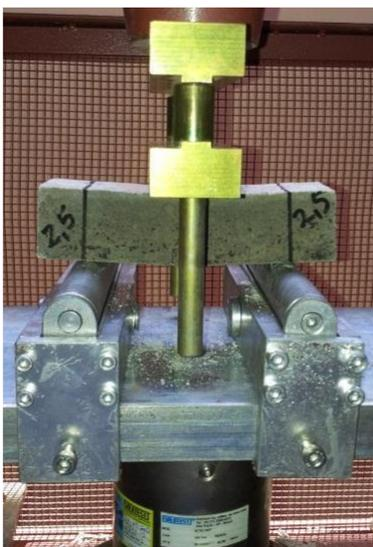
FIGURA 9: ENSAIO RESISTÊNCIA A TRAÇÃO NA FLEXÃO.
