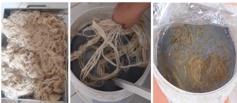
FIGURA 1: PREPARAÇÃO DAS FIBRAS DE CURAUÁ ATRAVES DE TRATAMENTO QUIMICO. FONTE: AUTORES (2018)
