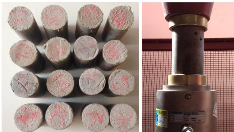
FIGURA 7: ROMPIMENTO DOS CP'S POR COMPRESSÃO AXIAL.
