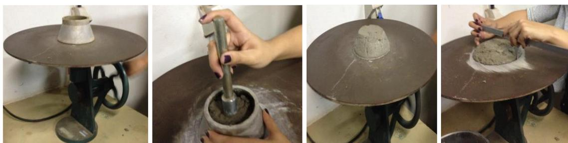
FIGURA 4: ENSAIO DE CONSISTENCIA DAS AMOSTRAS DE ARGAMASSA.
