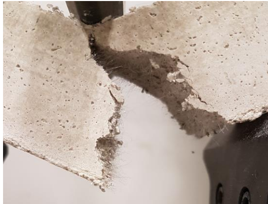
FIGURA 7: CORPOS DE PROVA COM FIBRAS FONTE: OS AUTORES, 2019
