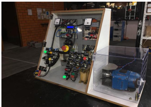
FIGURA 14 – BANCADA DIDÁTICA MONTADA FONTE: AUTORES (2019)
