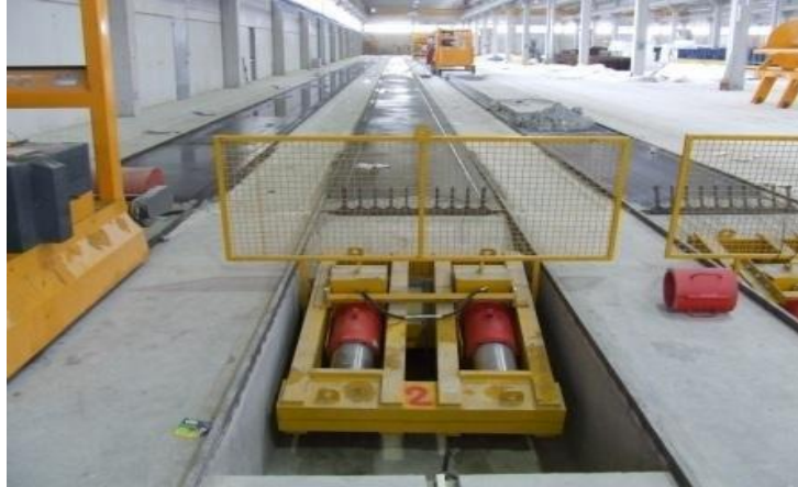
FIGURA 2: PISTA DE PROTENSÃO FONTE: OLMETITALY (2014)
