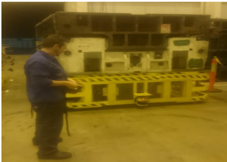
FIGURA 16 – DEMOSTRAÇÃO DA APLICAÇÃO DO VEÍCULO COM SISTEMA ELETRO-HIDRÁULICO MOVIMENTANDO UMA CARGA NO SETOR INDUSTRIAL FONTE: Autor (2017).
