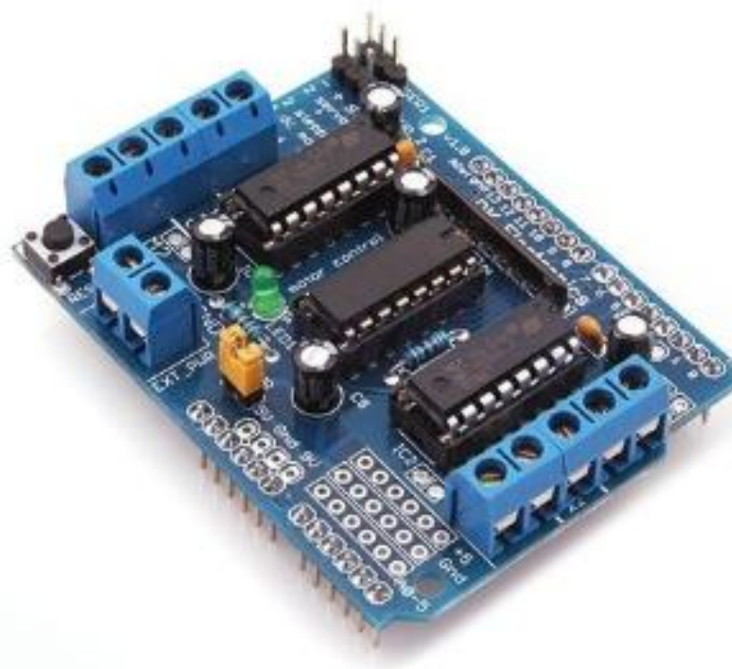
FIGURA 4: SHIELD L293D FONTE: OS AUTORES (2015)
