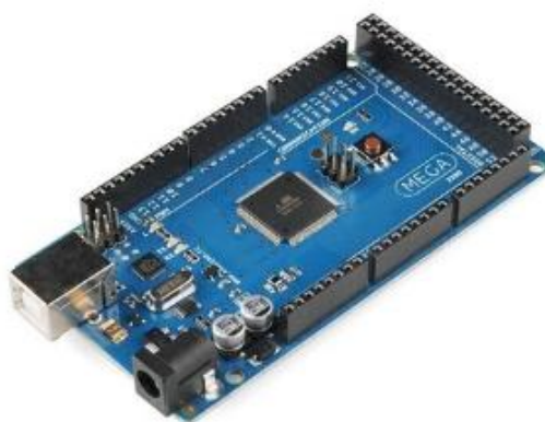
FIGURA 2: MICROCONTROLADOR ARDUINO FONTE: OS AUTORES (2015)
