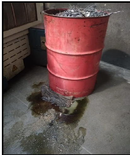
FIGURA 3: TAMBOR DE ACONDICIONAMENTO COM RESÍDUOS DE USINAGEM FONTE: AS AUTORAS (2019).
