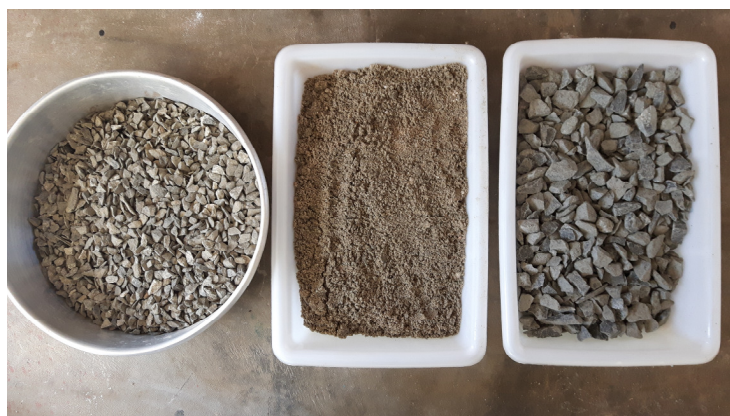
FIGURA 02 – AGREGADOS UTILIZADOS NA PESQUISA: (A) BRITA 0, (B) AREIA MÉDIA E(C) BRITA 1 FONTE: OS AUTORES, 2016.
