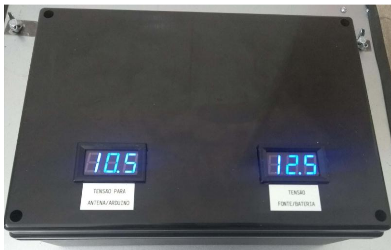
FIGURA 4 – MÓDULO DE ENERGIA. FONTE: AUTORIA PRÓPRIA (2018)
