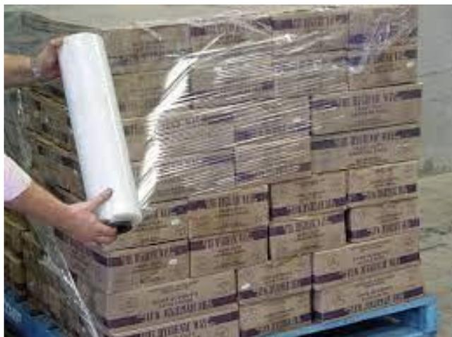
Figura 4 – Exemplo de carga estrechado
