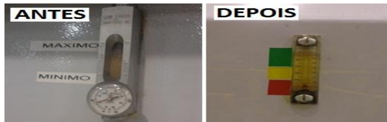
FIGURA 9: AÇÕES PARA REDUZIR O TEMPO DE INSPEÇÃO NA MÁQUINA. FONTE: OS AUTORES
