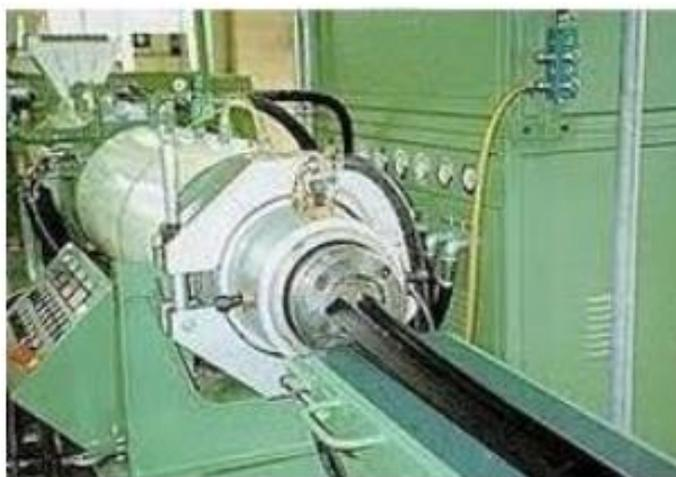
FIGURA 1: MÁQUINA EXTRUSORA DE BORRACHA UTILIZADA DE FABRICAÇÃO DE PNEU.
