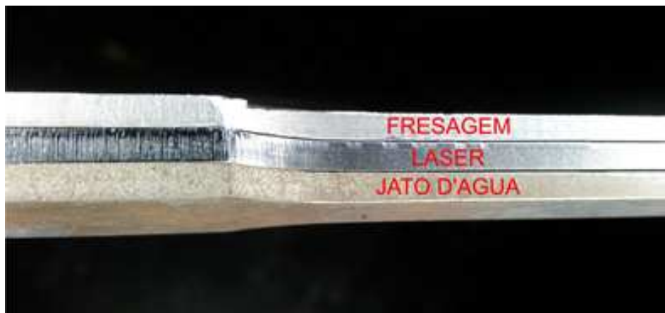
FIGURA 6 – ACABAMENTO DAS BORDAS DOS CORPOS DE PROVA FONTE: OS AUTORES, 2014
