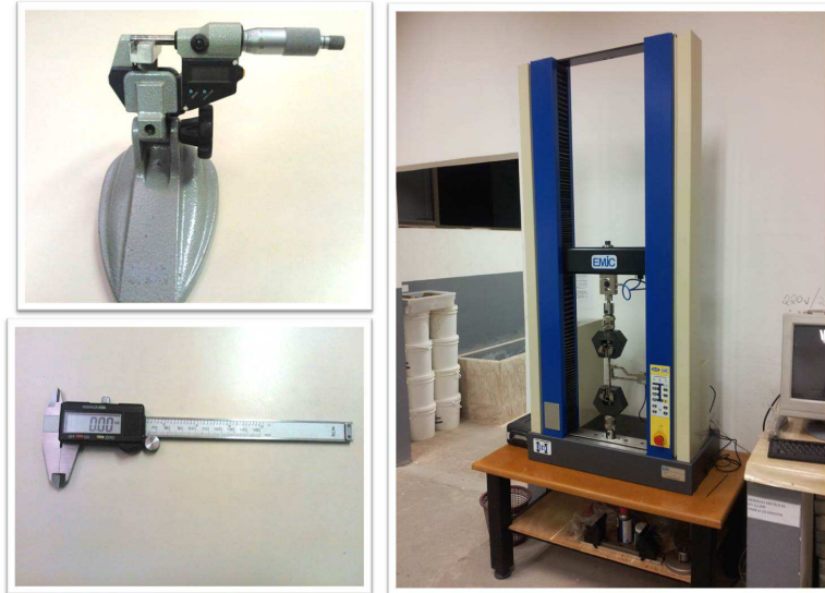
FIGURA 4 – MÁQUINA DE ENSAIOS, MICRÔMETRO E PAQUÍMETRO FONTE: OS AUTORES, 2014
