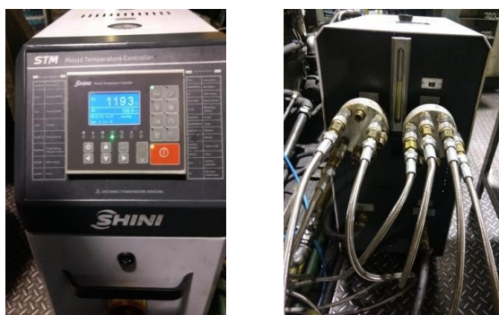
FIGURA 3 - SISTEMA DE REFRIGERAÇÃO A ÓLEO, CIRCUITO FECHADO
