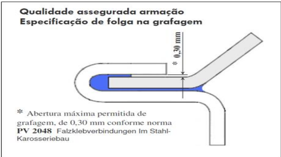
FIGURA 5 – CORTE GRAFAGEM FECHADA FONTE: KRUSCHE, et al. (2008). (ADAPTADO PELOS AUTORES)
