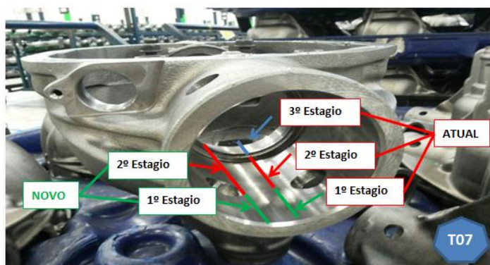
FIGURA 7: PERCURSO DE MANDRILAMENTO FERRAMENTA T07. FONTE: OS AUTORES, 2015.
