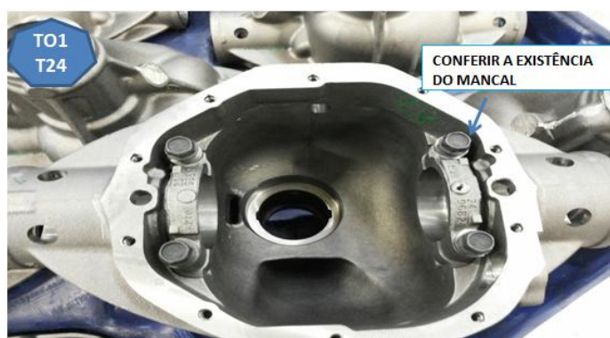
FIGURA 8: PROCESSO DE CONFERÊNCIA FERRAMENTA T01/T24. FONTE: OS AUTORES, 2015.
