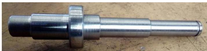
FIGURA 7: EIXO PARA FIXAÇÃO DA COROA SEM-FIM
