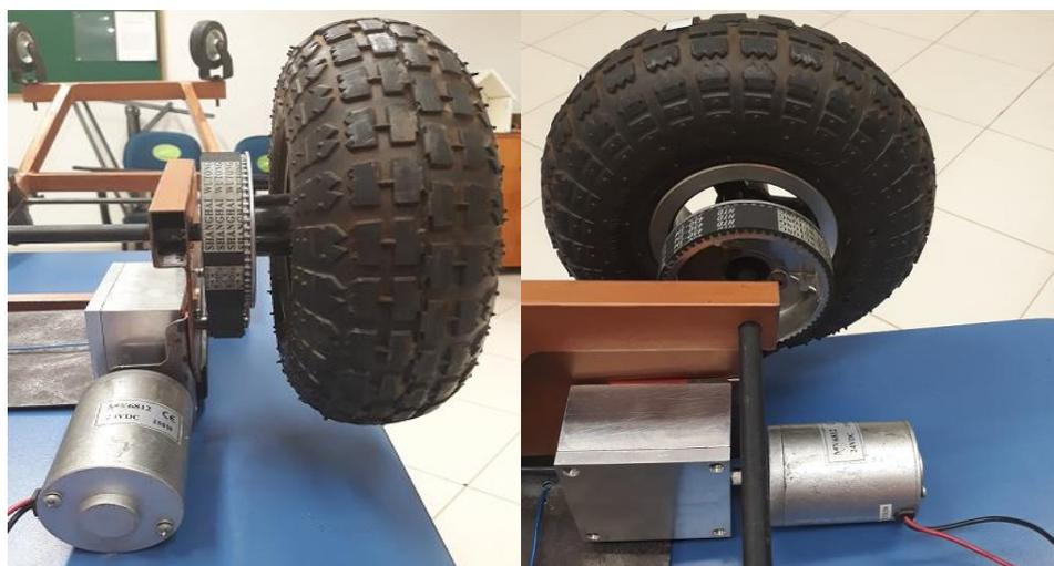
FIGURA 11: CORTADOR DE GRAMA COM OS DOIS SISTEMAS DE TRANSMISSÃO
