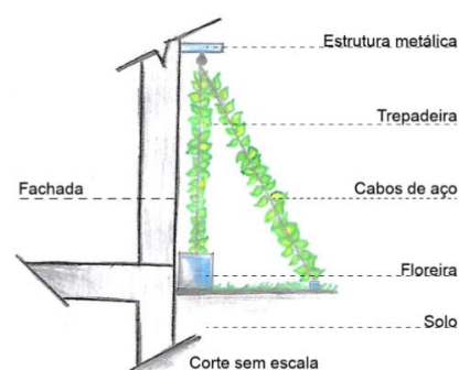
FIGURA 3 – SISTEMA DE CABOS FONTE: Os autores (2018).
