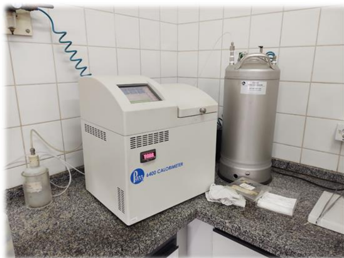
FIGURA 4 - CALORÍMETRO ISOPERIBÓLICO AUTOMÁTICO PARR MODELO 6400
